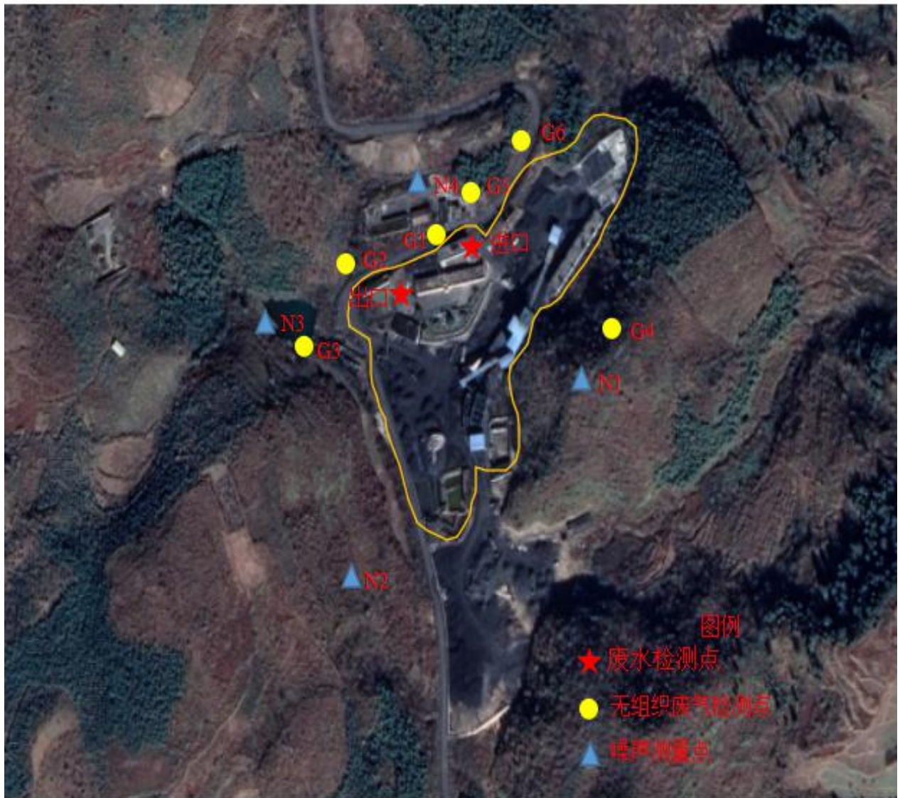
附图 1 兴仁县勇华洗煤厂 120 万吨/年洗选煤项目验收监测布点图
